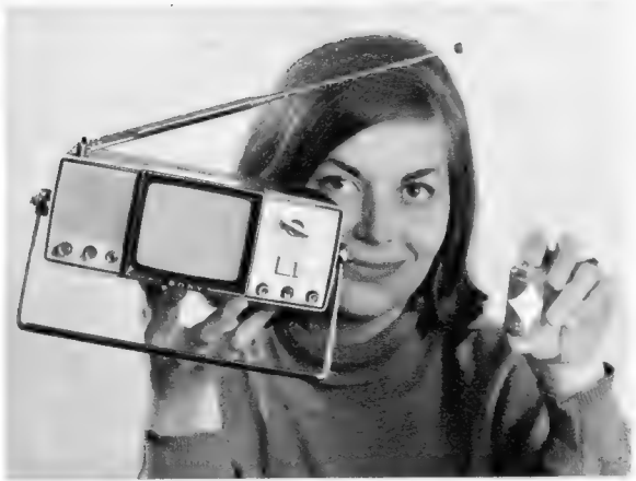
Links: Bild 5. Der angeblich kleinste Fernsehempfänger der Welt (Sony) mit 10-cm-Bildröhre und UHF-Teil. Neun der rechts sichtbaren Trockenbatterien reichen zum Betrieb aus
